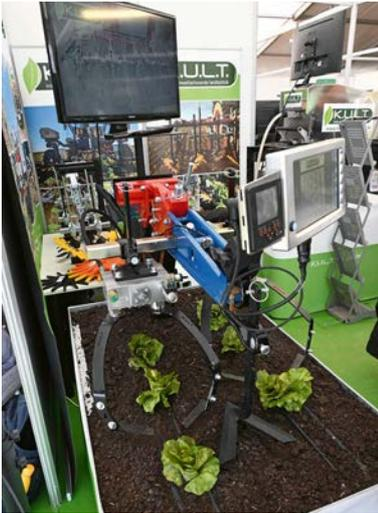
Les caméras haute résolution associées à l'intelligence artificielle permettent de travailler dans le potager avec une grande précision.
