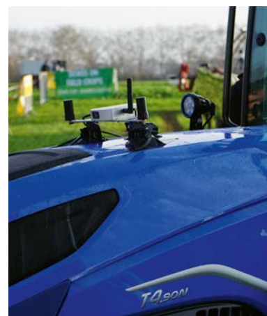
Auch Nachrüstsysteme für die präzise Lenkung konventioneller Traktoren wurden gezeigt.
