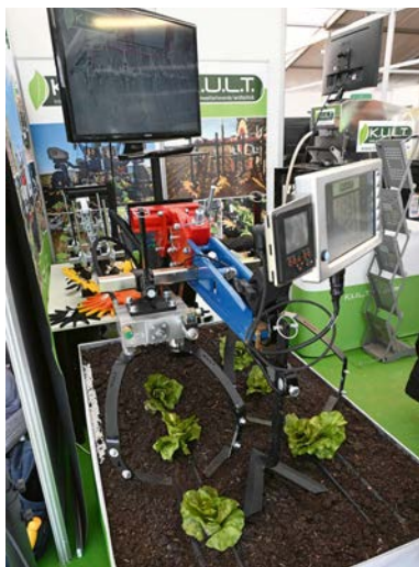
Hochauflösende Kameras kombiniert mit künstlicher Intelligenz ermöglichen hochpräzises Arbeiten im Gemüsebeet
