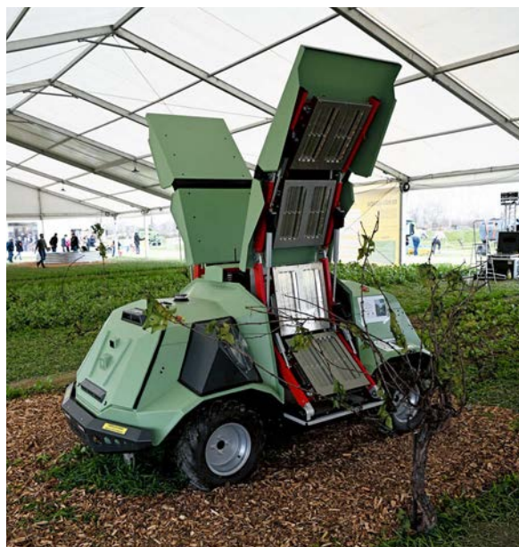
Der ICARO X4 von Masschio Gaspare bekämpft Rebkrankheiten mit UV-Licht.
