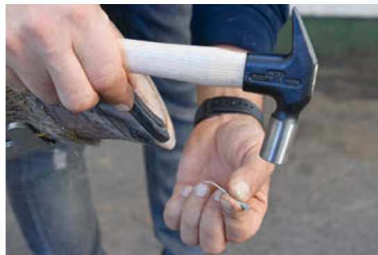
Der Nagel wird an der Zwicke mit einem leichten Bogen versehen. Le clou est doté d'un arc léger à son extrémité.
