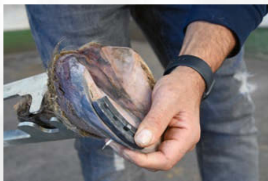
Der Nagel wird angesetzt und mit leichten Schlägen vorgetrieben. Le clou est posé et enfoncé avec de légers coups.
