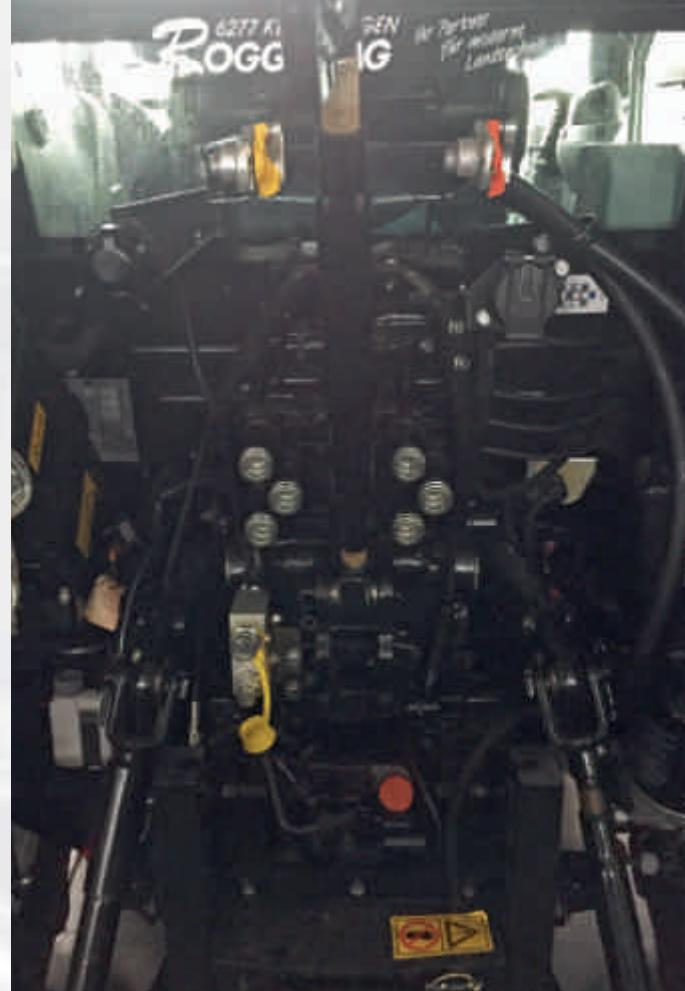
Eine hydraulische 2-Leitungsanhängerbremse kann nur kombiniert und mit Erkennung auch für alte 1-Leitungsanhängerbremse eingesetzt werden. Gleichzeitig muss eine ABS/EBS Steckdose vorhanden sein, damit neue Anhänger, die einen Hydrospeicher für die selbsttätige Bremse aufweisen, gekoppelt werden dürfen.
