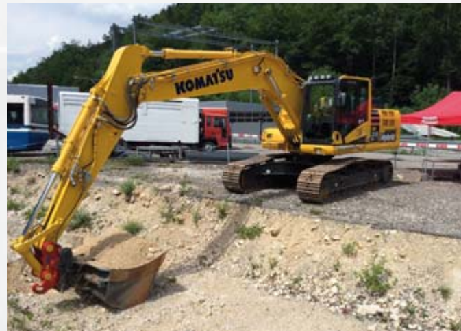
Komatsu HB 215LC-1 mit Hybrid-System.
