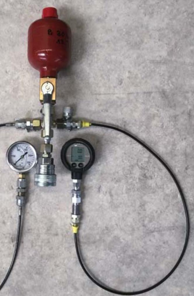
Das Problem liegt in der Messtoleranz der Manometer, der Wahl des Messbereichs des Manometers und der korrekten Einstellung des DBV (Druckbegrenzungsventil) im Anhängerbremseventil selbst.
