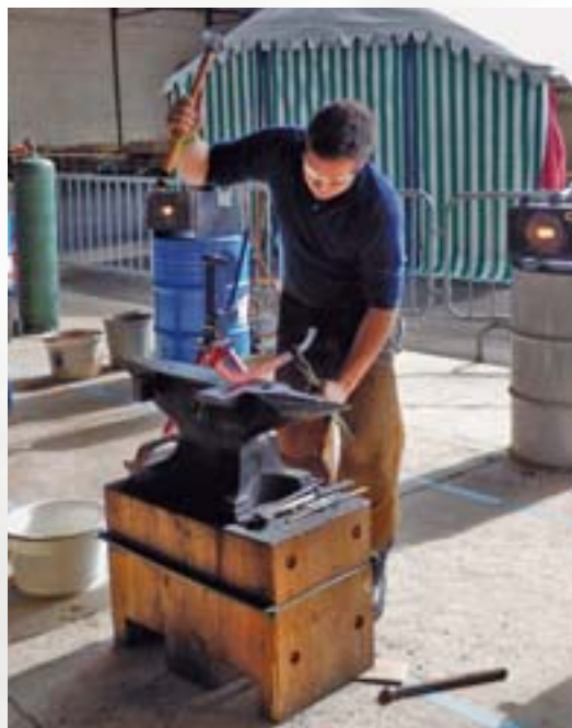
Ludovic Taillard (Kategorie 3, Lehrbeginn 2011), beim Schmieden des vorbereiteten Steghufeisens.
