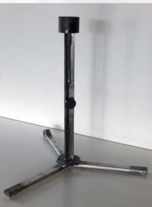
Abschlussarbeit in der Metallbearbeitung im ÜK 1: der Raspelbock.
