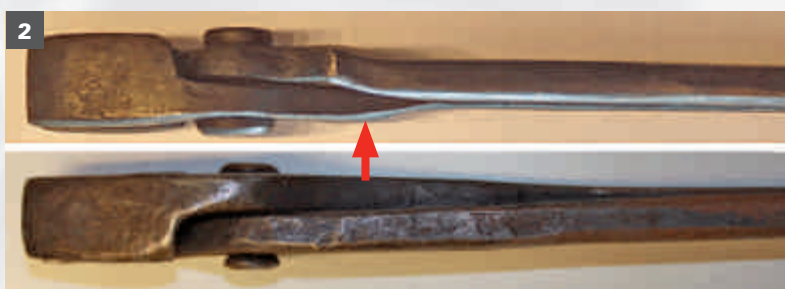
Versetzte Schenkel hinter dem Auge. Ajustage des branches derrière l'oeillet.
