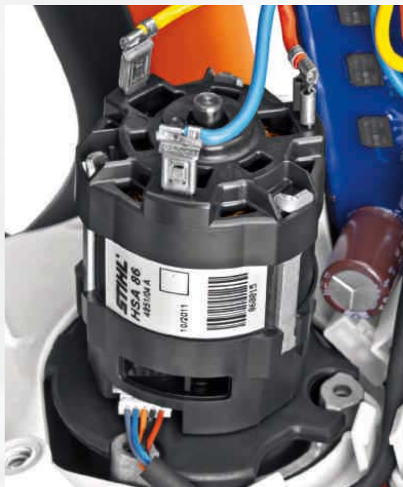
Bürstenloser, elektronisch geregelter Antriebsmotor (EC).
