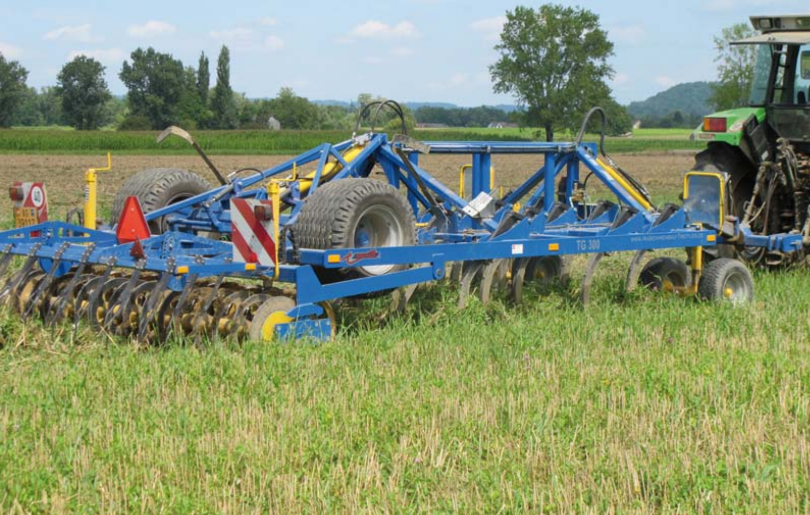
Le déchaumeur à dents, sans labour, ménage le sol : seuls les six premiers centimètres du sol sont travaillés, ce qui permet d'en conserver la structure.
