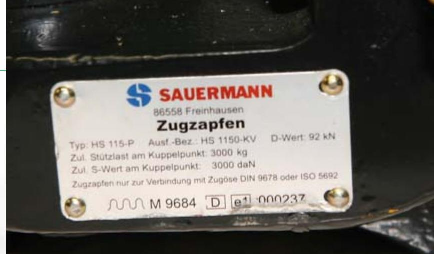
Für 40 km/h muss die Anhängerkupplung gekennzeichnet und drehbar sein.
