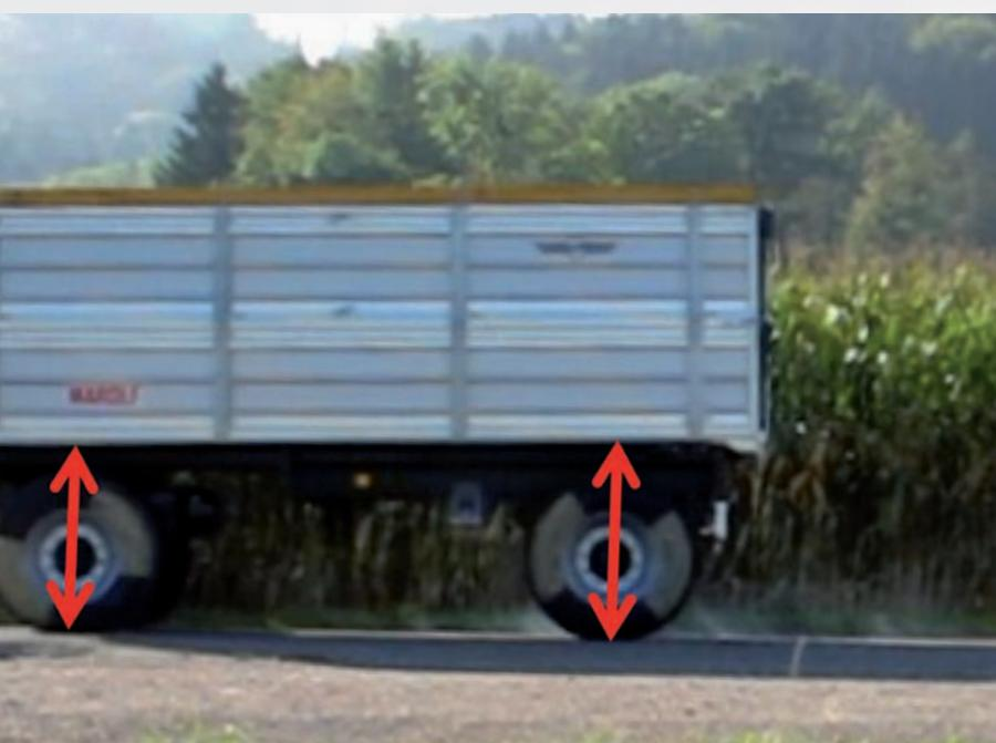
Dynamische Lastverteilung des Anhängers bei Vollbremsung. Durch die dynamische Lastverteilung bei der Bremsung wird die Vorderachse stärker belastet, die Hinterachse entlastet. Erkennbar ist dies durch die unterschiedliche Einfederung an Vorder- und Hinterachse.
