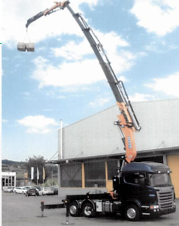
Kat. A, da mehr als 400'000 Nm (40 t/m) oder mehr als 22 Meter Auslegerlänge.
