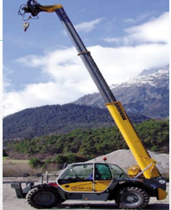
Kat. A, da mehr als 1'000 kg an der Seilwinde.
