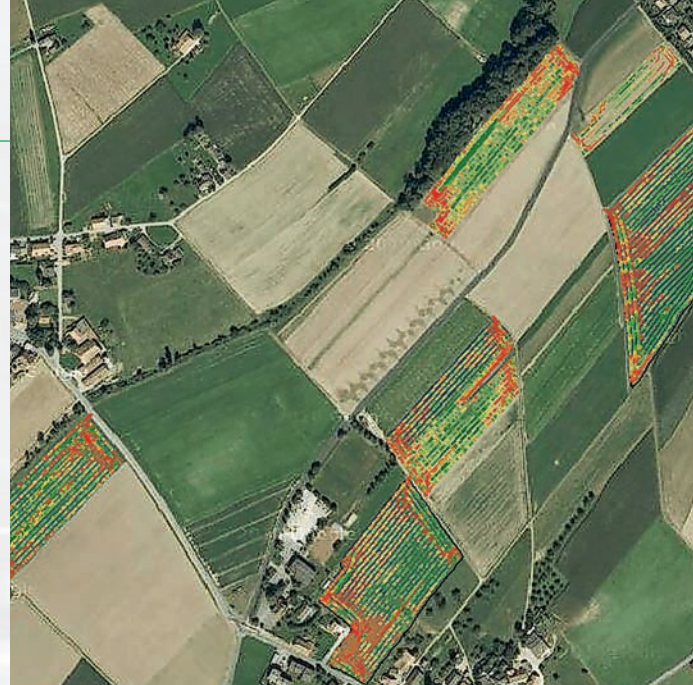
Die Aufzeichnungen eines Mähdreschers können in Form einer Ertragskarte dargestellt und beispielsweise für die Düngerdosierung in der Folgekultur verwendet werden.
