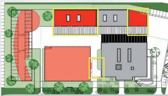
Die gelb eingerahmten Objekte werden realisiert: oben links Schulungshalle, oben rechts Maschinen- und Geräteunterstand, unten Garderobenausbau (unterirdisch).
