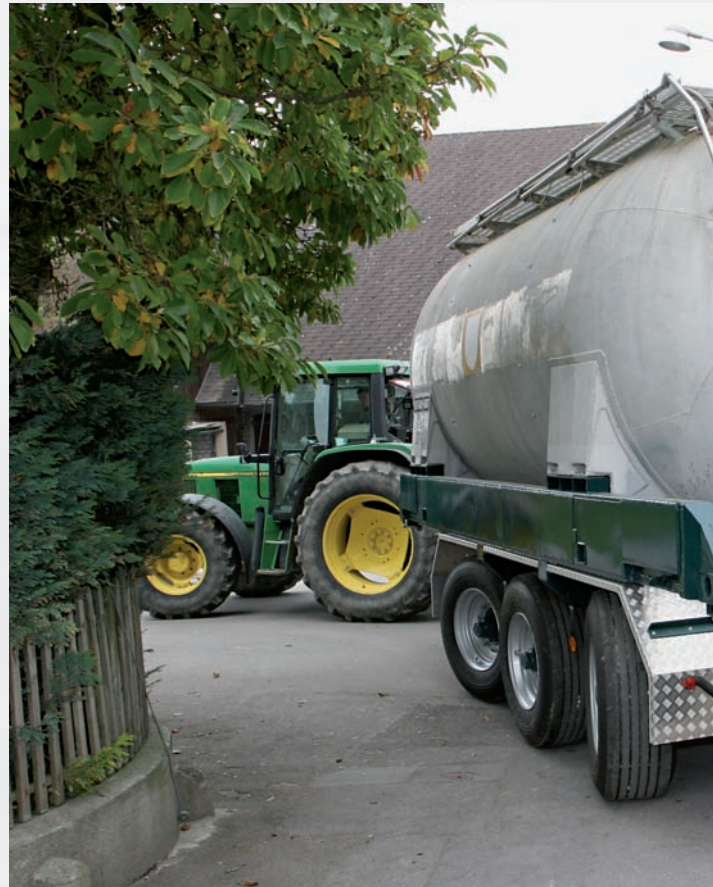
Die mittlere Achse ist starr und dient der Seitenführung. Die Erste und Dritte Achse sind gelenkte Nachlaufachsen.
