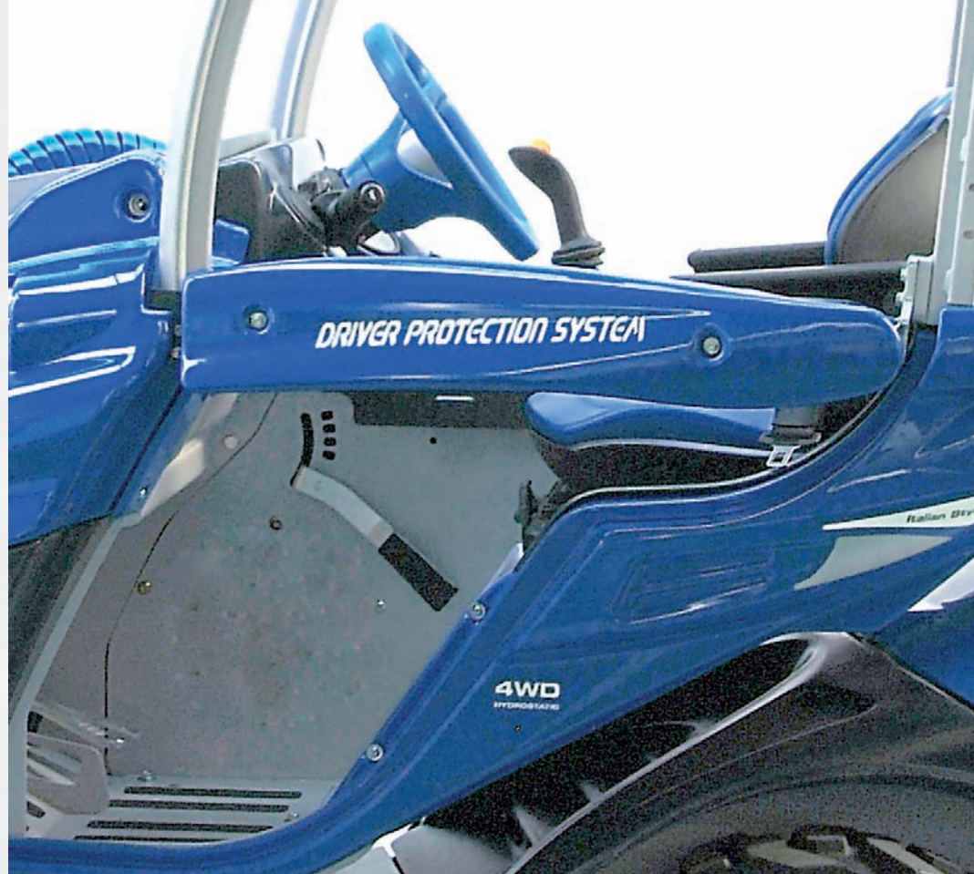
La marque Multione fait appel à cet arceau comme système de retenue du conducteur.
