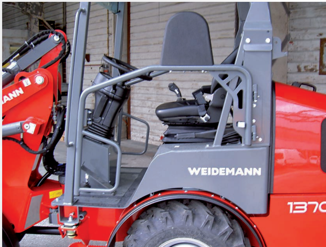
Weidemann intègre non seulement une ceinture de sécurité mais également une porte arceau s'ouvrant vers l'extérieur.
